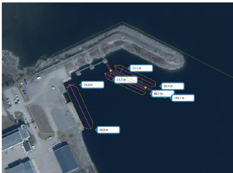
Figur 2-3. Illustration av m/s Sigrid vid kajplats 2 och fartyg för bergmassor vid kajplats 3 och 4 i alternativ 2.
