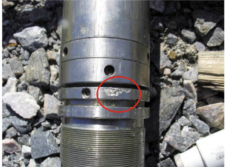
Korrosion av utrustning för kemisk analys (SKB P-05-265)
