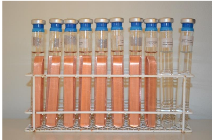
Figur 4-2. Förslutna provrör med koppar i rent, syrgasfritt vatten. Den 6 cm 3 stora gasfickan överst i provrören provtas regelbundet. Två av rören innehåller endast vatten och gas. Bilden togs då kopparn exponerats för rent, syrgasfritt vatten vid 70 °C i 27 månader.
