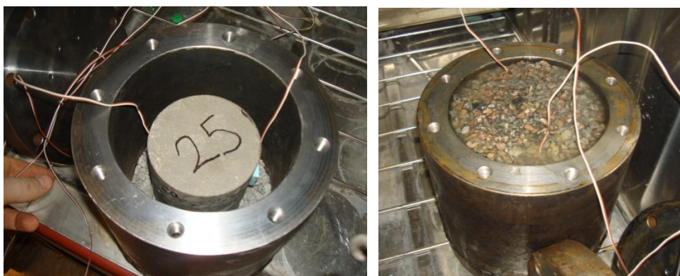
Figur 3-5. Försökupställning vid frysning av betongprover under inverkan av tvång. Bilden till vänster visar hur provet placerats i behållaren på en bädd av grus medan den högra visar behållaren helt fylld med vatten och grus innan locket skruvades fast.
