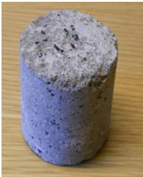
Figur 3-7. Prov som lakats och sedan frysts ner till -10 °C. Notera ytavskalningarna i toppen av provet. Denna del motsvarar den kraftigast lakade delen av provet.
