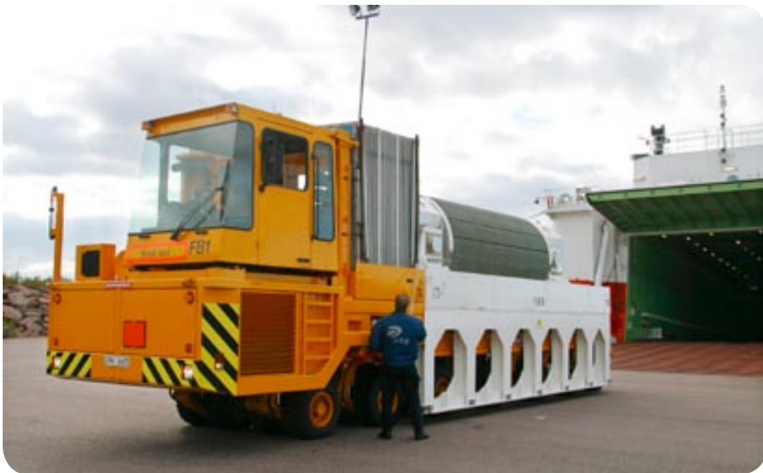
Figur 8-10. Transportfordon för transportbehållare.
