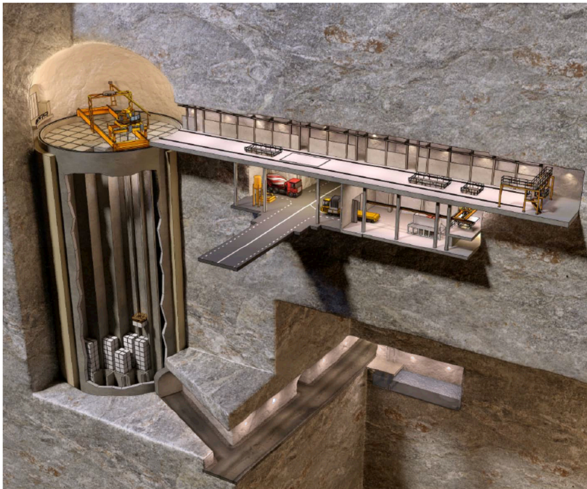
Figur B-1. Illustration av silo, inlastningsbyggnad, silotunneln, nedrebyggtunnel och silobottentunneln. Observera betongbjälklaget som delar inlastningsbyggnaden.
