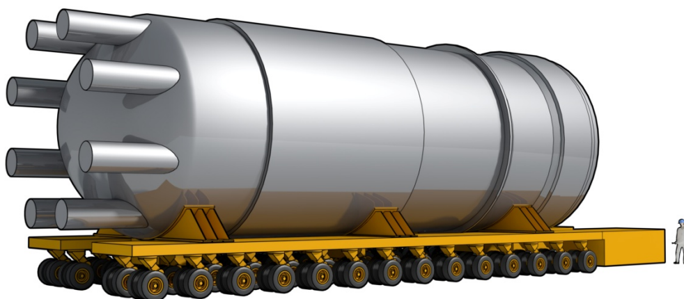
Figur 5-17 Illustration av två fordon av typen SPMT som kan kopplas ihop i moduler för att klara aktuella laster.
