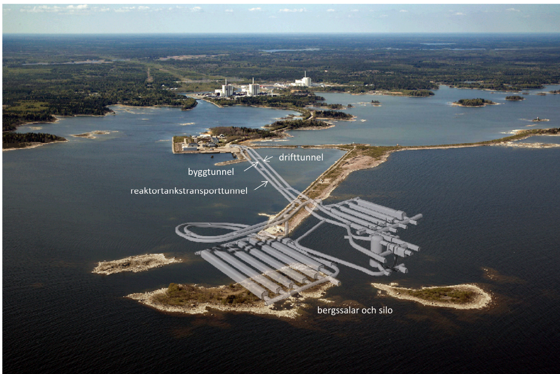
Figur 5-1. Schematisk figur över underjordsdelens olika bergssalar samt tillhörande tunnelsystem
