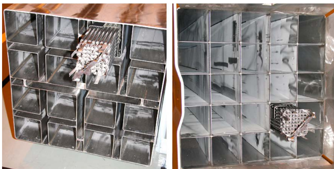
Figur 2-2. Till vänster visas en normalkassett som rymmer 16 bränsleelement av BWR-typ och till höger en kompaktkassett som rymmer 25 bränsleelement av BWR-typ.
