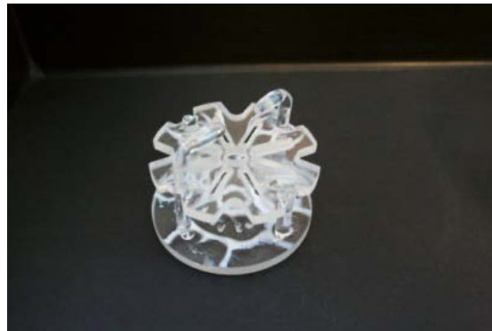
Figur 2-5. Reaktionskammaren med bägere och insatshållare med ett instucket kopparbleck.
