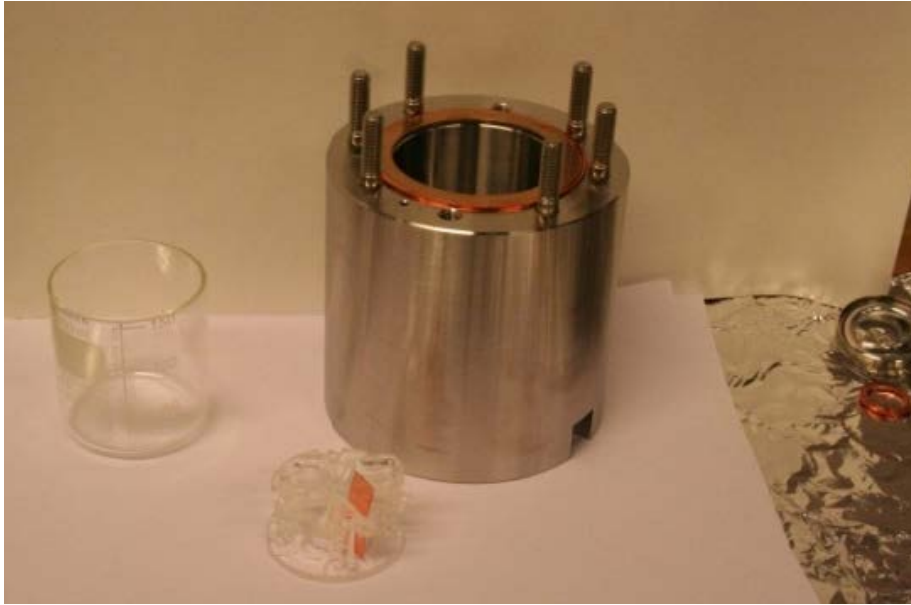
Figur 2-5. Reaktionskammaren med bägere och insatshållare med ett instucket kopparbleck.
