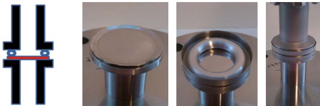
Figur 3-5. Skiss av tättningsring till palladiummembranet (t.v.) samt fotografier av monteringen (t.h.).
