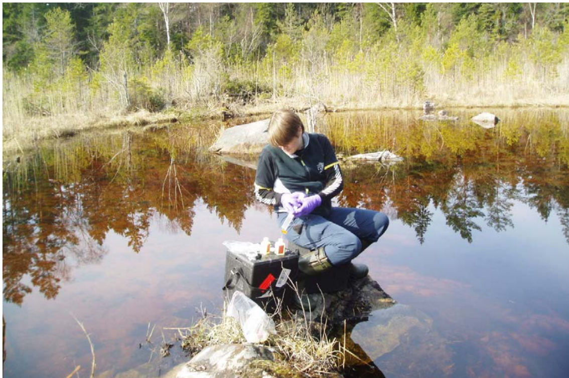
Figur 3-5. Filtrering av vattenprov vid aprilprovtagningen år 2012 i göl PFM7448.
