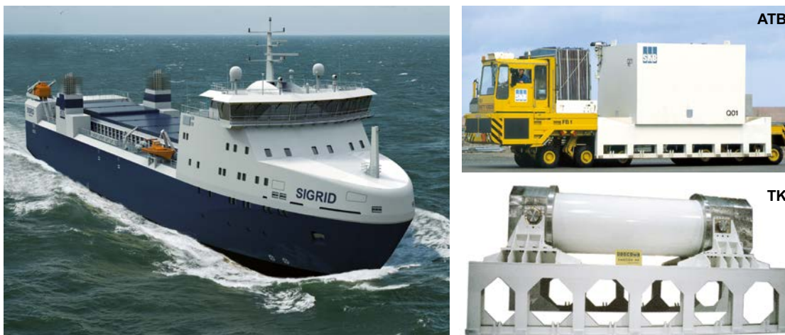
Figur 3-6. M/s Sigrid samt transportbehållare för kortlivat radioaktivt avfall (ATB) och för hårdkomponenter (TK).
