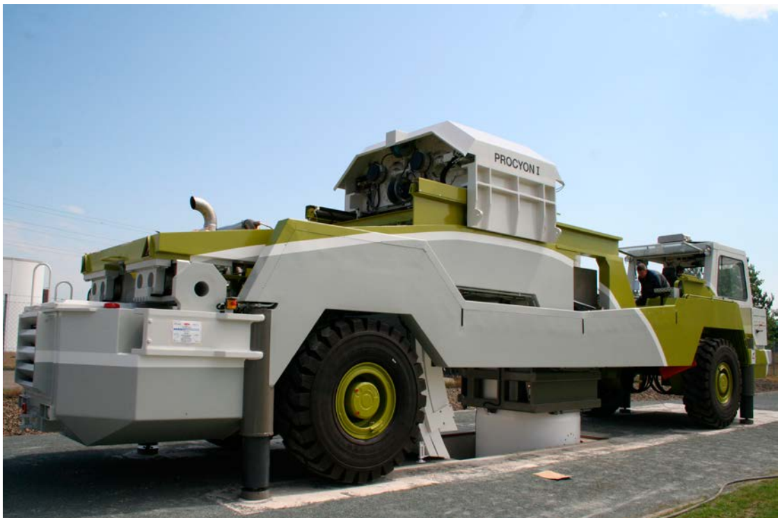
Figur 3-8. Deponeringsmaskin för hantering av kapslar i slutförvaret.
