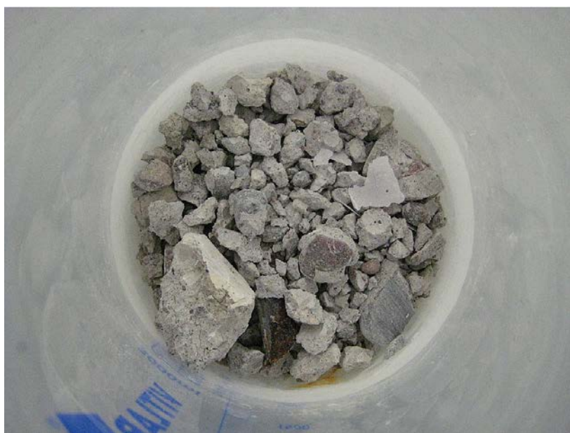
Figur 3-1. Exempel på sönderfrysens provkropp liggande i plastbägare.
