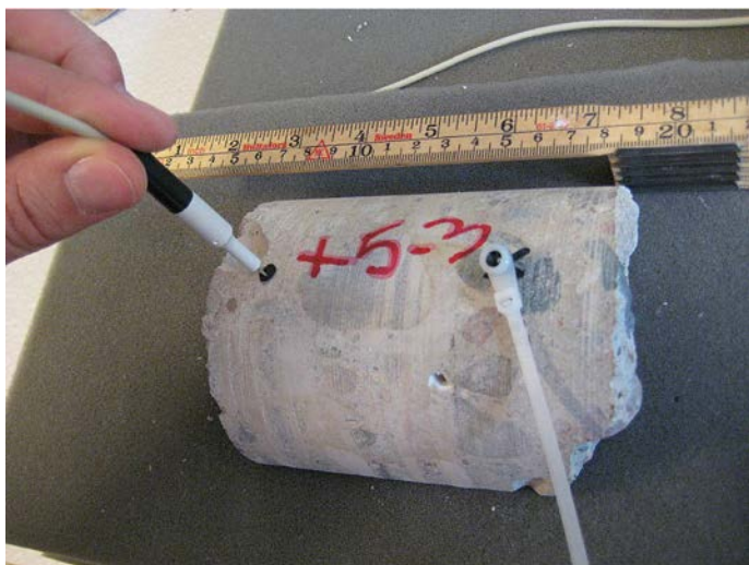
Figur 2-2. Halvmåneformad provkropp liggande på mjukt underlag. Ett lätt slag görs med sändaren till höger i bild och mottagaren hålls still vid markerad punkt till vänster.
