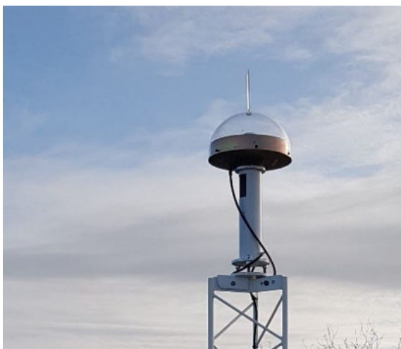
Figur 6-15. Den så kallade radomen – skyddshuven på antennen har en pigg på toppen, som ska göra att måsar och andra fåglar inte ska vilja sitta på radomen och därmed skymma antennerna.
