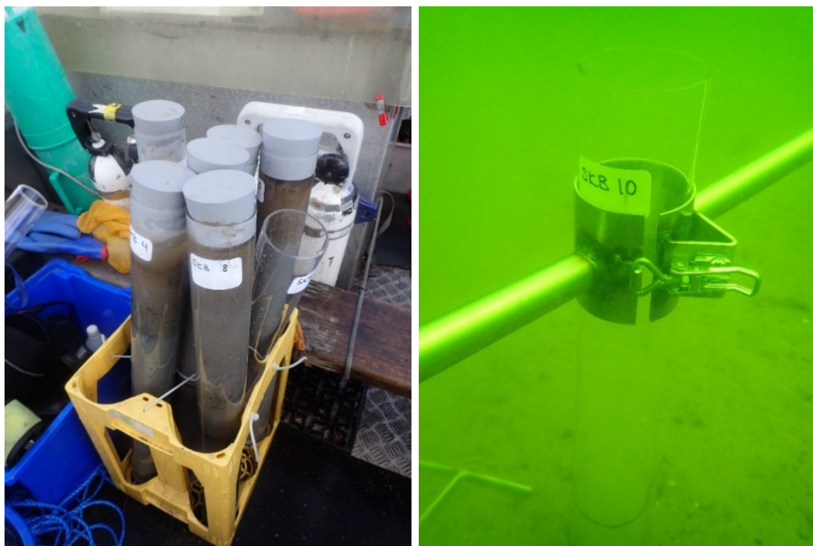
Figur 2-2 Vänster: Sedimentprover försedda med gummikorkar. Höger: Provtagningsutrustningen på plats vid provpunkten. Ett handtag på röret gör det lättare att trycka ner plexiglasröret genom sedimentet.
