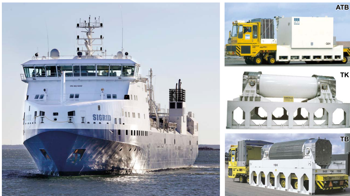
Figur 2-9. M/s Sigrid samt transportbehållare för kortlivat radioaktivt avfall (ATB), för hårdkomponenter (TK) och använda bränsleelement (TB).
