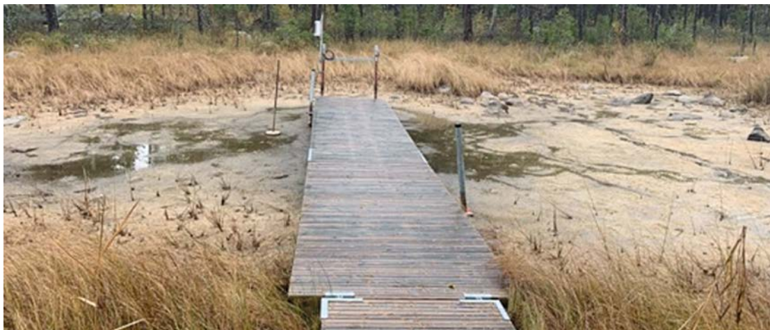
Figur 4-1. Bild tagen på göl 16 i Forsmark den 6 oktober 2020. Vattennivån var enligt pegelröret SFM000115 (ett av de två rören som sticker upp längst ut på bryggan) vid tidpunkten som bilden togs (kl 13:00) 2,209 m (RH 2000). Enligt kontrollmätningarna som utfördes längst ut på bryggan är mjukbottenytans nivå 2,225 m och hårdbottenytans nivå 2,065 m (tabell 3-2).
