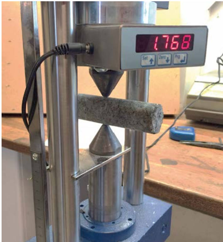
Figur 2-1. Borrhärna monterad för provning med punklasttestare (PLT).
