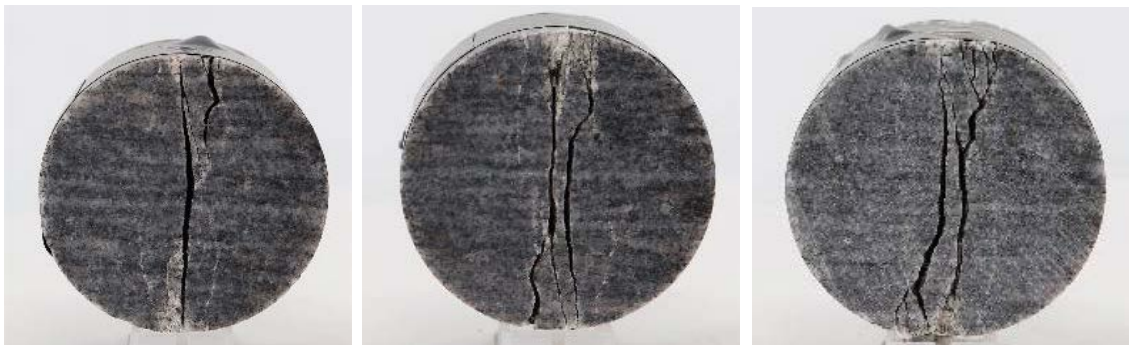
Figur 4-2. Foton av de 21 stycken ITS-prover som gjorts i denna studie. Bergarten är granit till granodiorit (bergartskod 101057) och fotografierna är tagna efter draghållfasthetsprovningen som skapat sprickan (se även brödtexten för kommentarer). Foton är från Lägermo et al. (2021).
