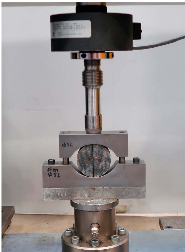
Figur 2-7. Uppställning för indirekt draghållfasthetsförsök (ITS). Från Lägermo et al. (2021).
