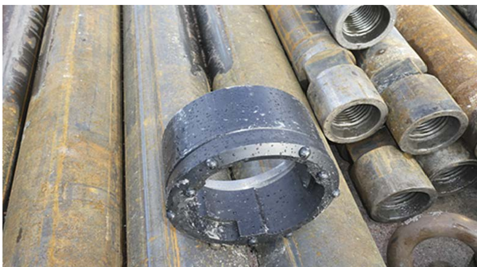
Figur 4-3. Ringborrkrona för foderrörsborringen genom fyllnadsmassorna på piren för de fyra traditionella borrhålen.
