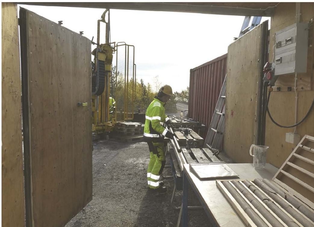
Figur 4-12. När innertuben har vinschats upp från borrhålet pumpas borkärnan ut för kontroll av längdmått innan den läggs i borkärnelådan.
