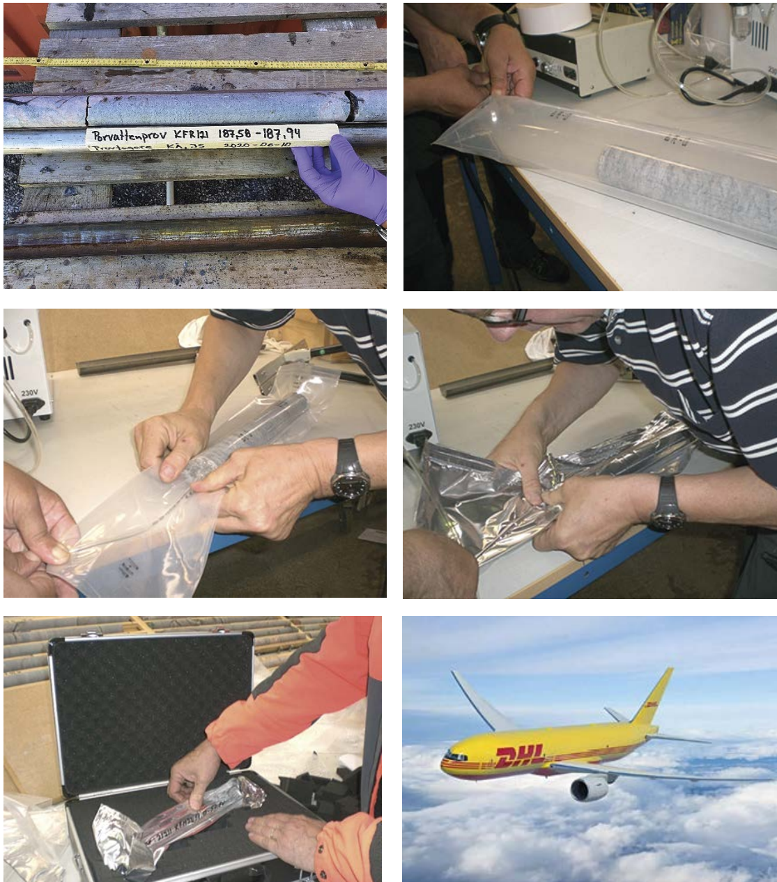
Figur 5-11. Bildserien visar den omfattande hanteringen vid provtagning av borrhänsor för analys av porvatten. Provet tas ut direkt efter att borrhänsan kommit upp ur borrhälet. Provet läggs i en plastpåse som fylls med kvävgas så att all luft pressas bort. Därefter sugs gasen ut med vakuumpump. Proceduren upprepas med ytterligare en plastpåse, och därefter utförs samma procedur för den tredje och sista påsen av aluminiumfolie. Borrhänsan packas i vadderad väska och skickas omedelbart med flygfrakt från Arlanda till laboratorium i Tyskland. Sammanlagt tio prover från KFR121 har skickats iväg för porvattenanalys.
