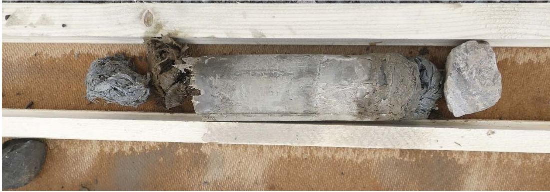
Figur 5-10. Den bortborrade pluggen samt en 3 cm kort borrhärna kom med upp ur borrhålet.
