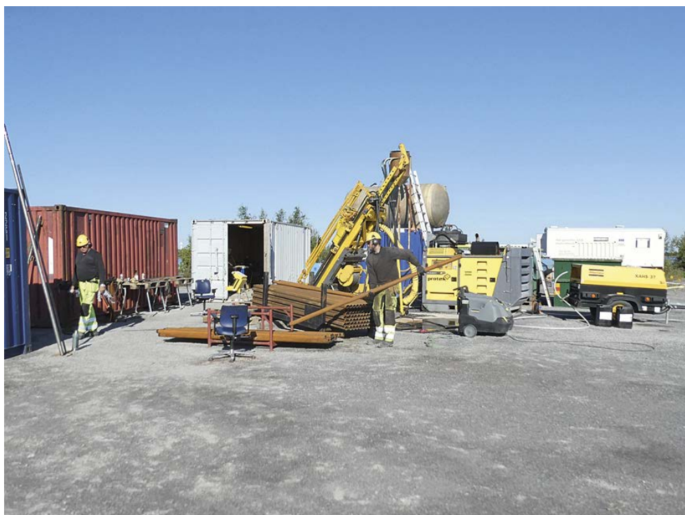
Figur 3-5. Kärnborrmaskin med kringutrustning på borrhplatsen för KFR121.
