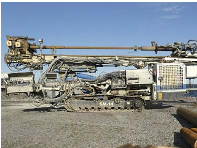
Figur 3-1. Den larvgående hammarbormaskinen Soilmec SM-14.
