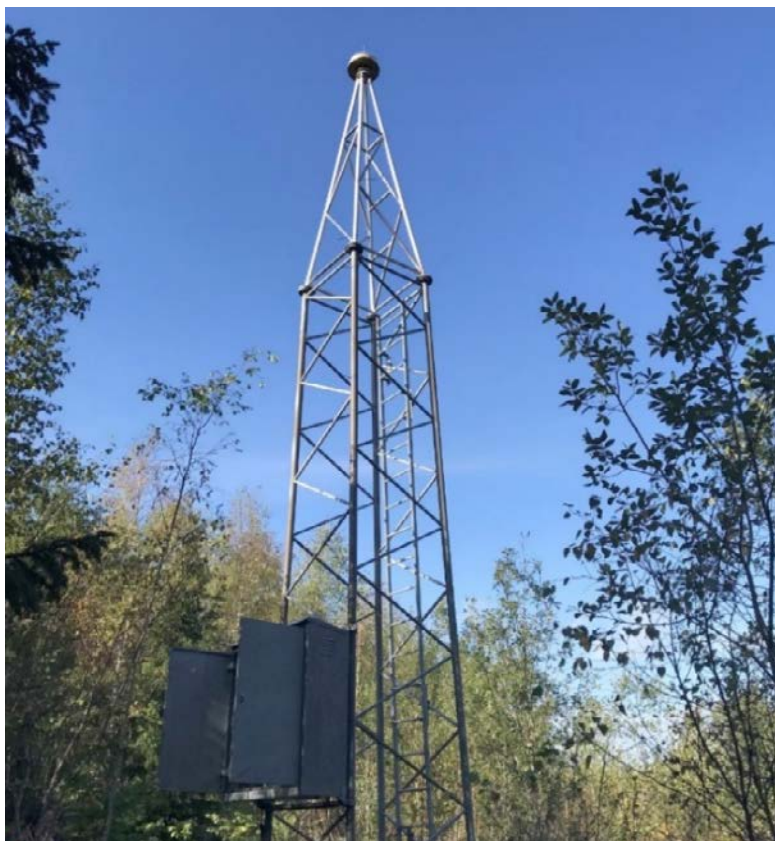
Figur 3-4. Referensstation Storskäret (SSKA.0), nyttjande av befintlig mast samt med specialfäste. Foto: Hans-Åke Åström.
