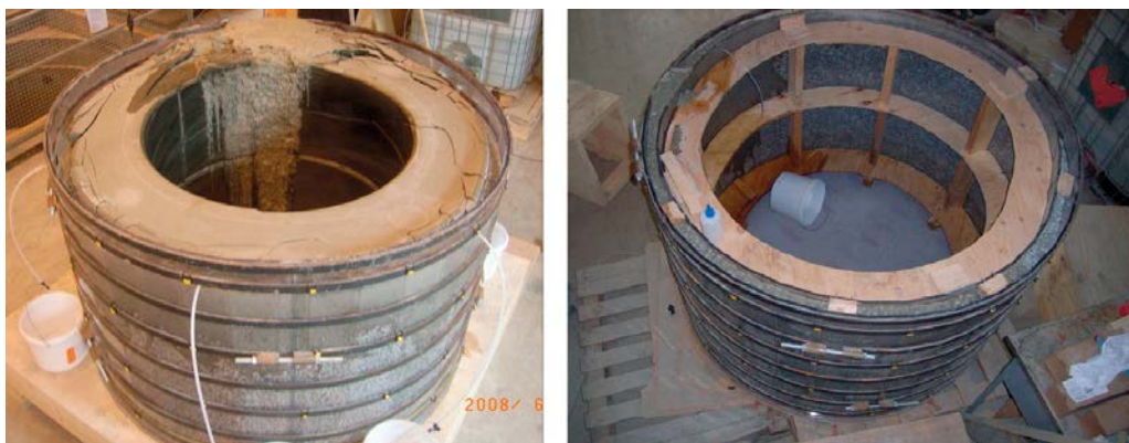
Figur 2-3. Uppställning för att studera hur vatten fördelar sig i en pelletsfylld spalt. Försöken är genomförda i en utrustning som simulerar ett fullskaligt deponeringshål (rätt diameter) (Åberg 2009, s 12–13).
