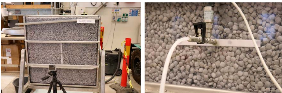
Figur 4-4. Simulering av sprickinflöde med plastfilter.
