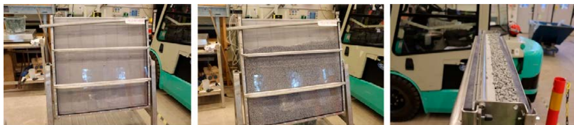
Figur 4-2. Foto tagna vid installation av block (vänster) samt extruderad buffertpellets (mitten, höger) Test 3.
