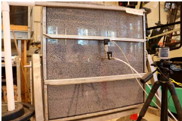
Figur 4-3. Punktinflöde för Test 3. En tryckgivare anslöts till bevätningssystemet.
