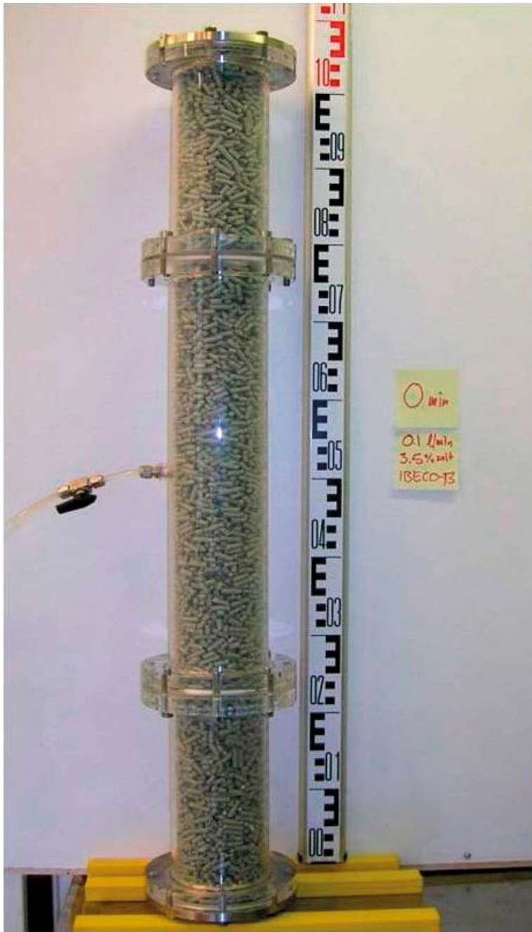
Figur 2-2. Försöksuppläggning som användes för att studera pelletsfyllningars förmåga att hålla och distribuera vatten (Andersson och Sandén 2012, s 28).
