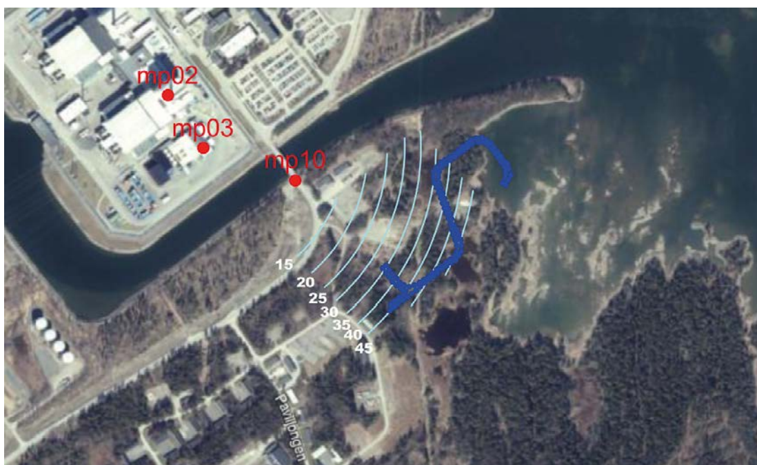
Figur 8-1. Karta 1, prognostiserade maximala tillåtna laddningsmängder, kg vid markytan, lämplig vid planering av tunnelpåslag, schakt samt eventuell sprängning för husgrunder.
