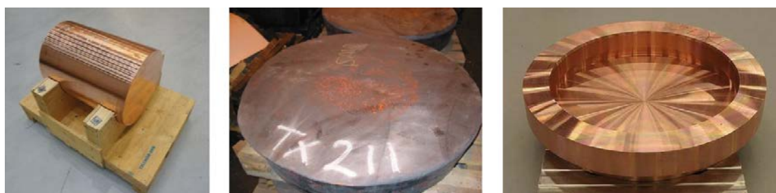
Figur 1-2. Bilden till vänster visar ett smidesämne färdig för smidning till ett lockämne, i mitten visas ett smitt lockämne. Bilden till höger visar ett maskinbearbetat lock.
