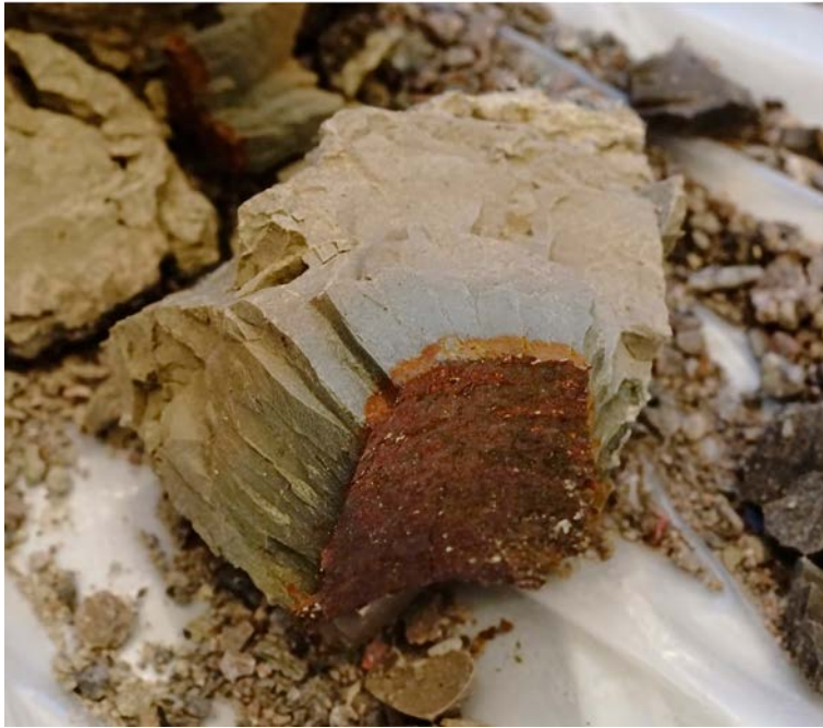
Figur 11-13. Prov med Calcigel-bentonit från ABM:s försökspaket 5, vilket togs upp 2017.
