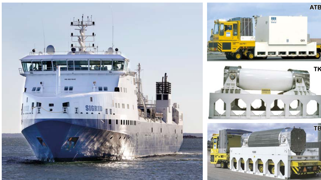
Figur 2-10. M/s Sigrid samt dagens transportbehållare för kortlivat radioaktivt avfall (ATB) för hårdkomponenter (TK) och använda bränsleelement (TB).
