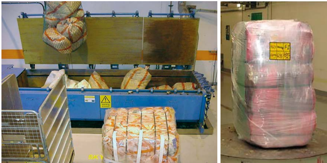
Figur 3-4. Tv balpress för kompaktering av mjukavfall; t h färdigpressad avfallsbal.
