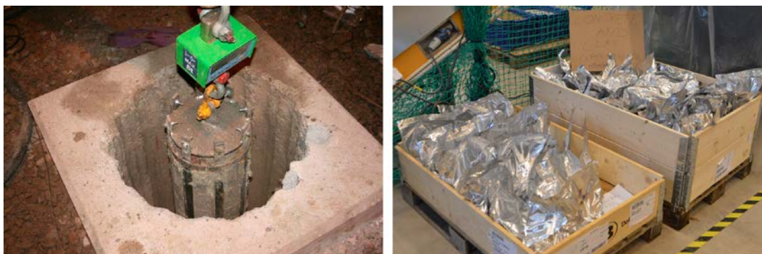
Figur 10-1. Återtag av ett paket med 30 bentonitblock (vänster bild). Varje block innehåller även fyra mindre materialprover varför blocken delas i fyra delar och vakuumpförpackas inför analys (höger bild).
