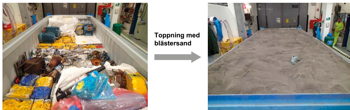
Figur 3-3. T v metallfraktion till markförvar packad i halvhöjds ISO-container; t h toppfylld med blästersand för att utnyttja volym och minimera tomrum (montering av lock tillkommer innan deponering).
