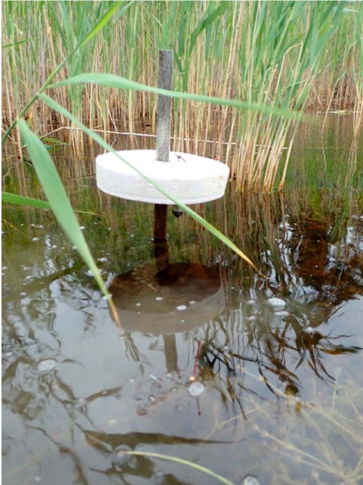
Figur 4-4. Den 12 juni noterades det att mätaren i gölen AFM001419 fastnat på stången och hängde i luften. Detta har sannolikt skett när vattennivån i gölen sjunkit.
