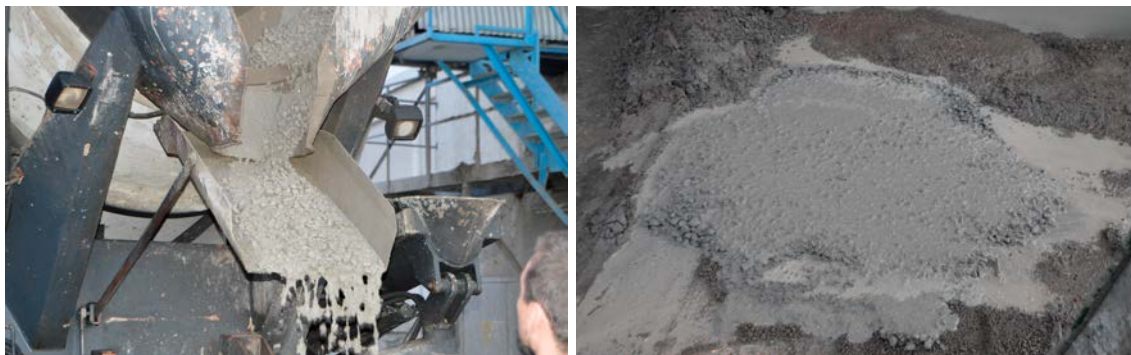
Figur 8-3. Bilderna visar betong tillverkad med recept Kalmar 3. Det syns tydligt hur betongen separerar både när den tippas ur betongbil och när den hälls ut på en platta på marken.
