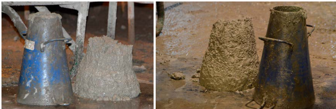
Figur 8-4. Bilderna visar mätning av sättnmätt för betong tillverkad med recept Kalmar 4 direkt efter blandning samt efter 2 timmars transportsimulering.
