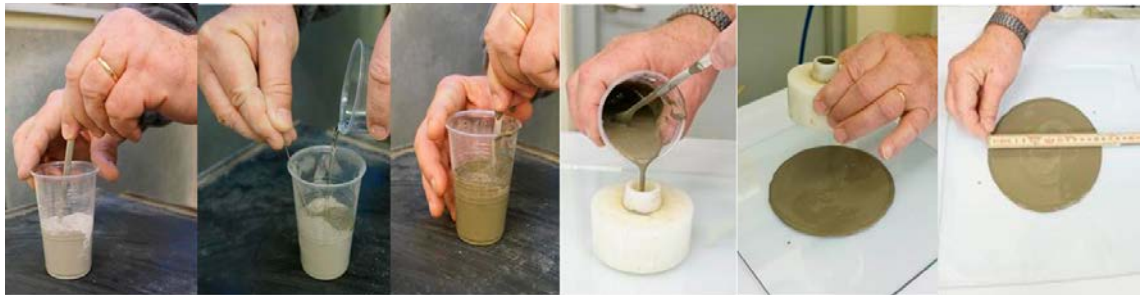
Figur 4-9. Mätning av utflyt av mikrobruk. Utflytet görs på en glasplatta och diametern mäts. Utflytet ger en indikation på flytgränsspänningen. Genom att mäta tiden för att nå fullt utflyt får man en uppskattning av den plastiska viskositeten. Den använda minikonens har en toppdiameter av 19 mm, en basdiameter av 38 mm och en höjd på 57 mm.
