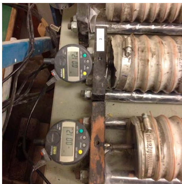
Figur 7-1. Utrustning för mätning av autogen krympning. Mätning genomförs på en horisontellt placerad provkropp.
