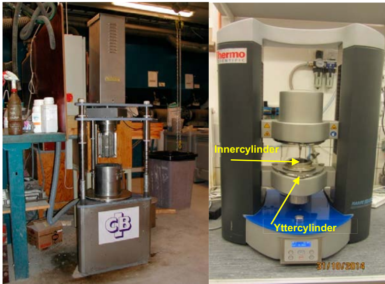
Figur 2-1. Viskometer, ConTec 4-SCC, för reologisk karakterisering av bruk (tv) och Viskometer, MARS III, för reologisk karakterisering av bruk (th).
