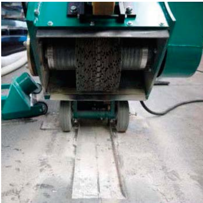
Figur 4-23. Undersidan av en betongshaver.
