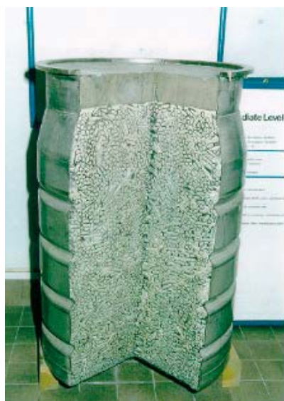
Figur 6-14. Snitt av immobiliserat avfall i betong (vänster) och polymer (höger).
