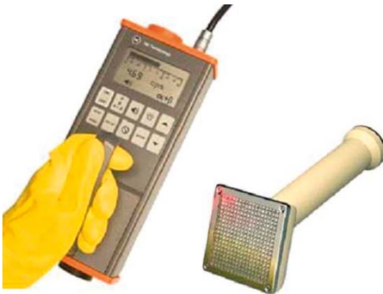
Figur 4-4. ELECTRA och prob för kontaminationsdetektion.
