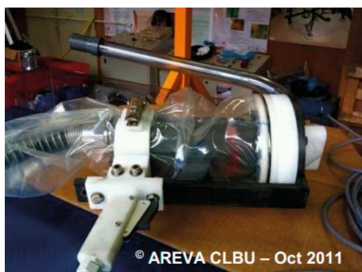
Figur 3-10. Handhållen laserdekontaminering (AREVA).
