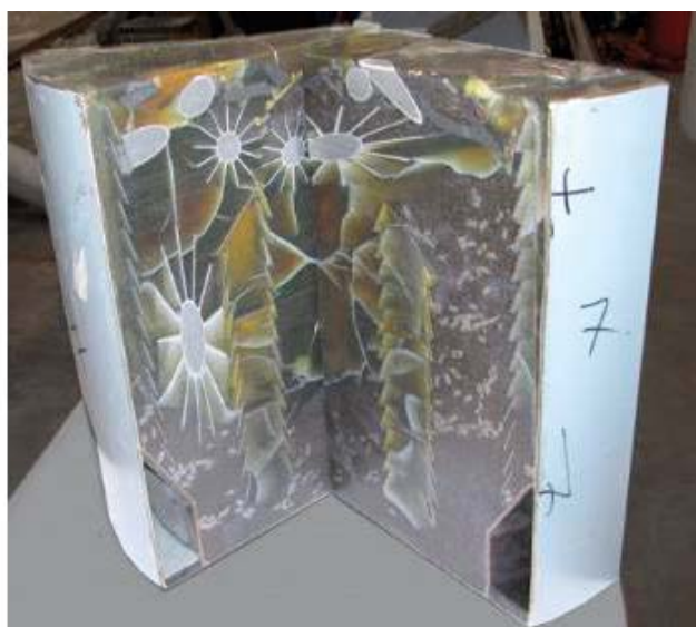
Figur 6-14. Snitt av immobiliserat avfall i betong (vänster) och polymer (höger).
