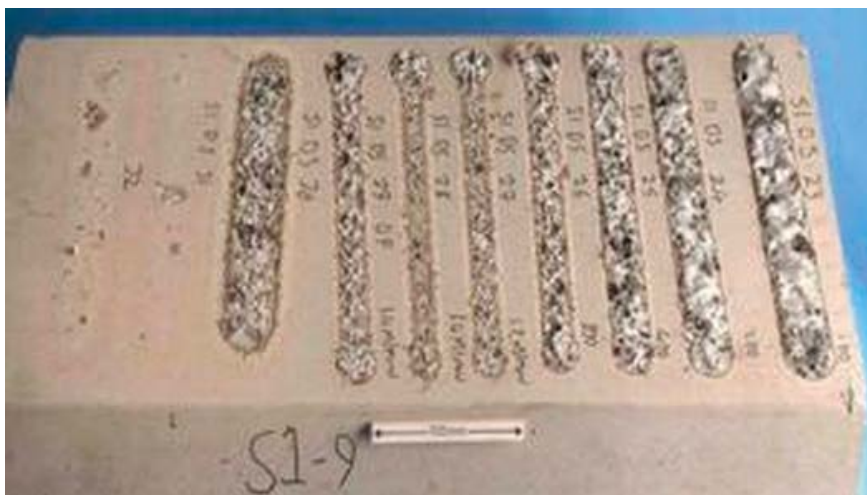
Figur 4-25. Laserbehandling på betong som innehåller kiselöreningar.
