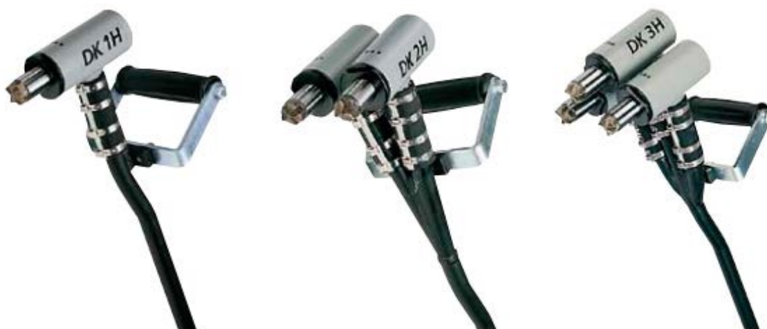
Figur 4-15. Pneumatiska handhållna scabblar.
