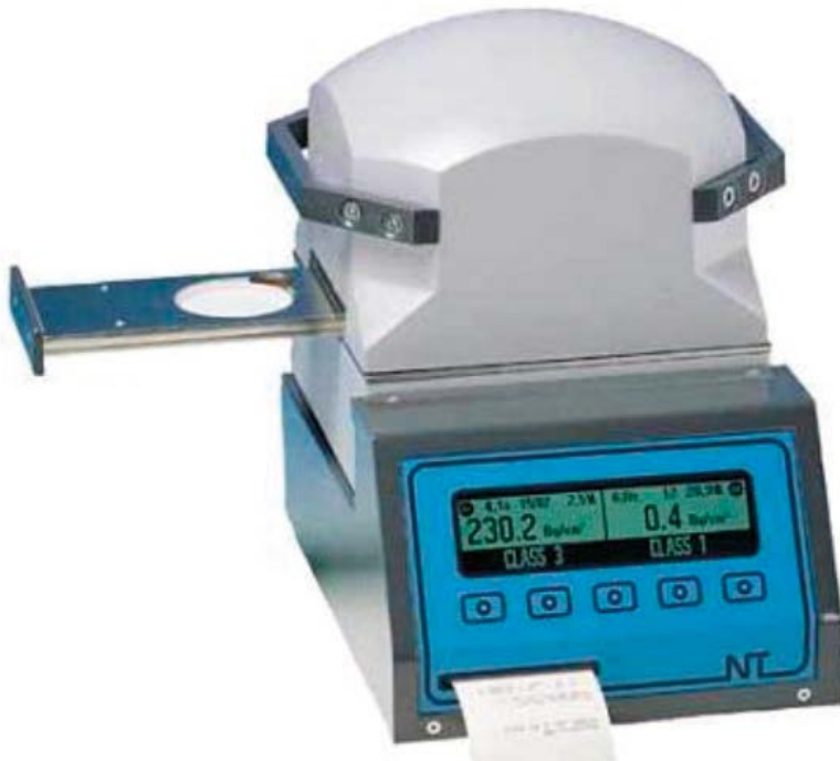
Figur 4-3. Nutronic NT200 analyser.
