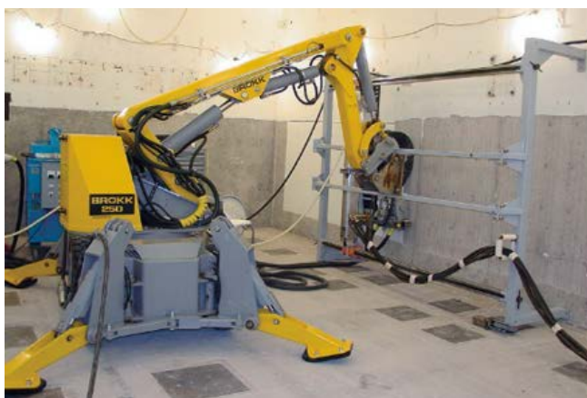
Figur 4-20. Vägshaver monterad på rivningsrobot samt gaffeltruck.
