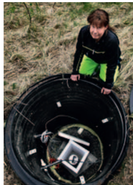
Susanna Andrén visar hur den seismiska stationen är installerad nere i en brunn, på berget.
