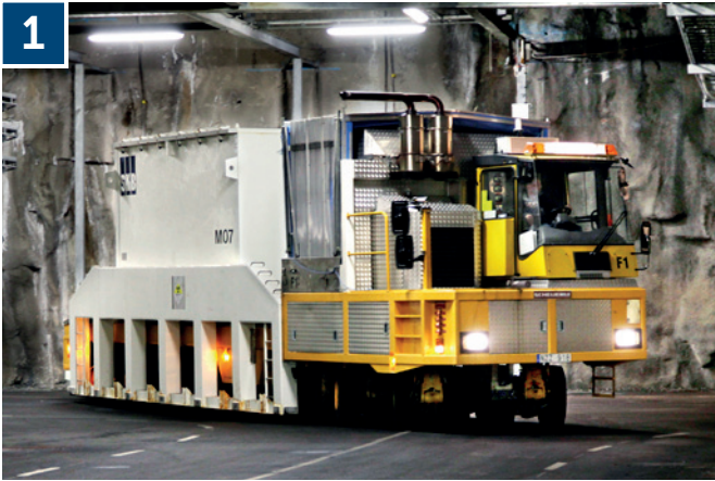
1 Avfallet kommer till SFR med SKB:s fartyg m/s Sigröd och körs ner i anläggningen av ett särskilt anpassat transportfordon.
