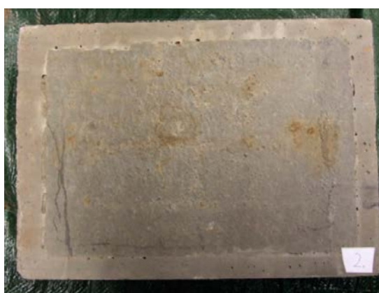
Figur 4-3. Låg-pH-betong exponerad för klorider (Sederholm et al. 2014).
