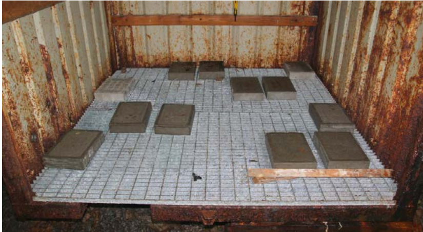
Figur 2-2. De 12 kvarvarande betongblocken i containern i Äspölaboratoriet.
