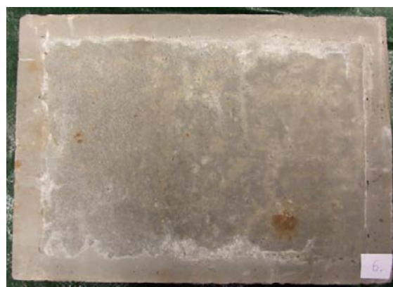
Figur 4-2. Låg-pH-betong utan klorider (Sederholm et al. 2014).
