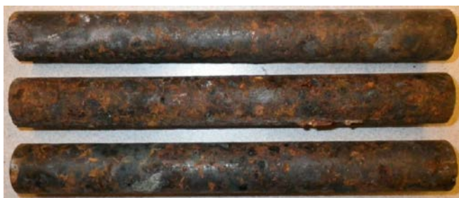
Figur 4-9. Stålstänger som varit ingjutna i låg-pH-betong med ingjutna klorider efter fem års exponering i Äspö tunneln (Sederholm et al. 2014).
