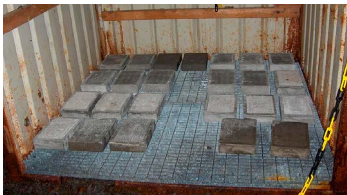
Figur 2-1. Exponering av betongblock i container i Äspölaboratoriet. Containern har ett skyddande tak för att hindra att betongblocken utsätts för droppande bergvatten. En sida av containern är helt öppen mot tunnel, ursprunglig provuppsättning med de 24 betongblocken (Bodén och Pettersson 2011).
