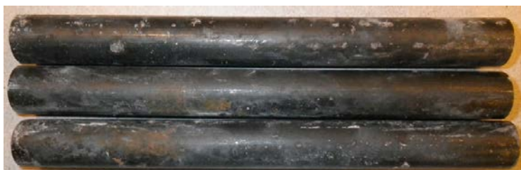
Figur 4-7. Stålstänger som varit ingjutna i en låg-pH-betong exponerad för kloridlösning efter fem år i Äspölaboratoriet (Sederholm et al. 2014).
