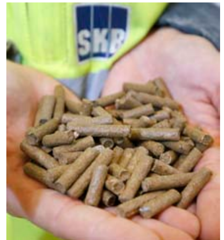
Den nya pressen tillverkar pelletar som i första hand ska användas vid återfyllning av deponeringstunnlar.
