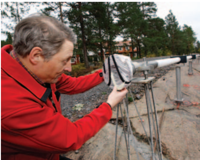
Göran Nilsson inspekterar den nya krökmättningsanläggningen på Åspö.
