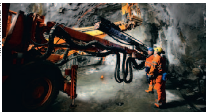
Borriggen gör cirka 90 hål inför varje sprängsalva.
