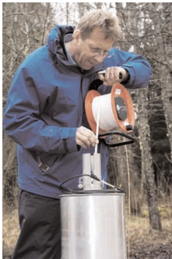
Per-Olof Johansson kontrollerar grundvattennivån i ett av jordborrhålen i Forsmark.
