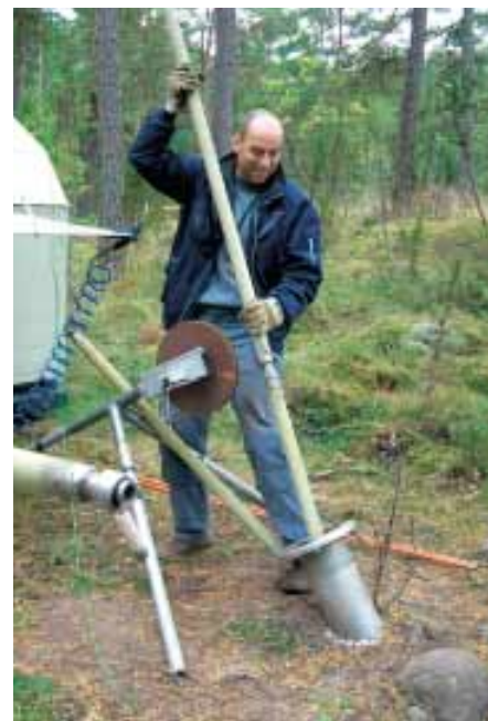
Ett kärnborrhål på Ävrö undersöks med borrhålsradar. Christer Gustafsson, Malå GeoScience, håller i radarantennerna.
