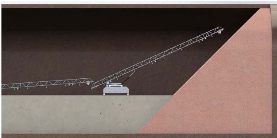
Figur 7-3. Figuren visar sista enheten på matarbandet, kastaren. Kastaren har frihetsgrader både vertikalt och horisontellt för att täcka hela frontarean.
