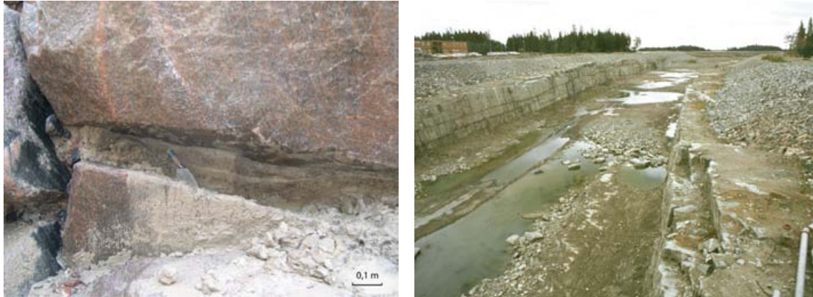
Figur 4-24. a) Skiktad silt i en öppen spricka i den nordvästra delen av det utgrävda området vid borrhålsplats 5. Denna plats var ursprungligen täckt med morän som har avlägsnats. b) Horisontella sprickor längs den mer än 1 km långa kanalen mellan Östersjön och kärnreaktorerna i Forsmark. Dessa sprickor har tolkats som bankningsprickor, som uppstår i samband med tryckavlastningen på berggrunden (figur 11-2 i Platsbeskrivning Forsmark ).
