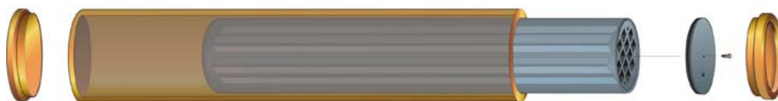
Figur 5-9. Sprängskiss av kapselns komponenter (från vänster: kopparbottendel, kopparrör, insats, stållock till insats och kopparlock).
