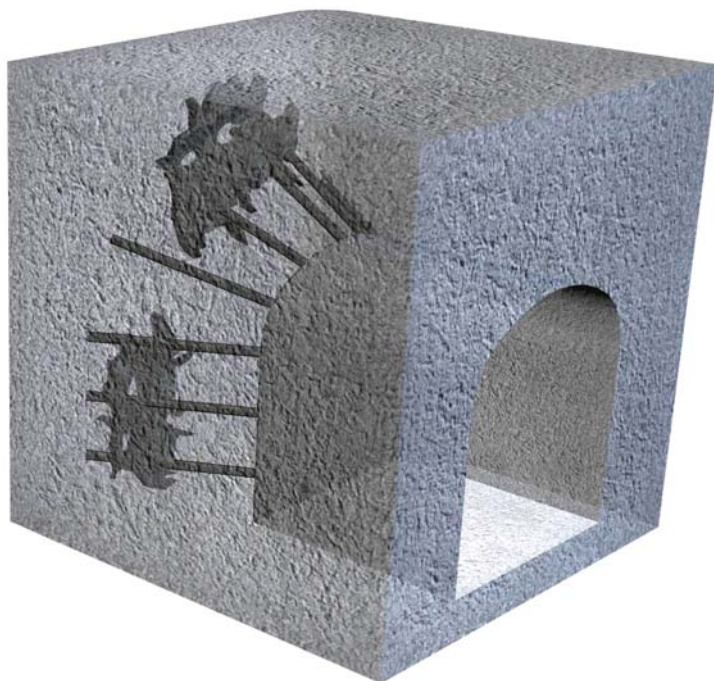
Figur 2-7. Illustration av del av en injekterad zon (injekterings-skärm) kring en tunnel /Emmelin et al. 2007/.
