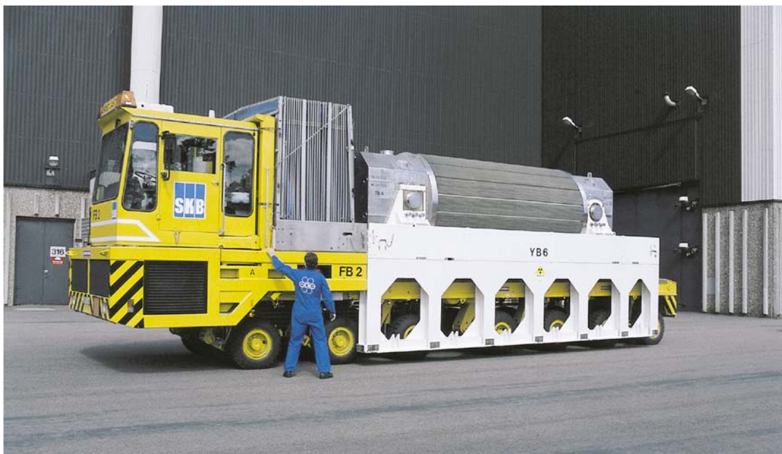
Figur 3-6. Terminalfordon med transportbehållare för bränsleelement .
