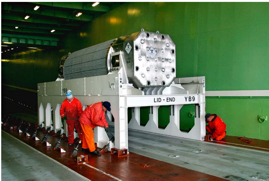
Figur 5-4. Bränsletransportbehållare, lastad på m/s Sigyn.
