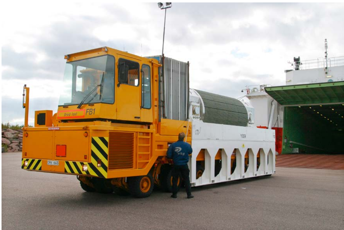
Figur 5-2. Terminalfordon, här lastat med bränsletransportbehållare för transport till Clab.
