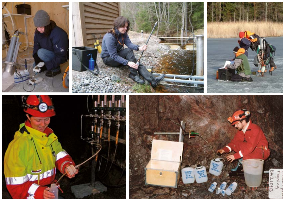
Figur B3-15. Övre raden: hydrokemisk fältprovtagning och analys under platsundersökningen i Forsmark i, från vänster, djupt borrhål, bäck och sjö. Nedre raden: grundvattenprovtagning i underjordsmiljö (Åspölaboratoriet).
