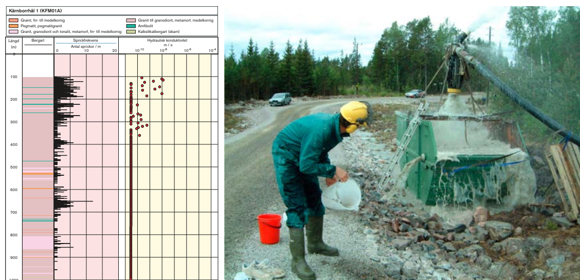
Figur B3-14. Illustration av kontrasten i hydraulisk konduktivitet mellan berggrundens ytligare och djupare delar inom Forsmarks kandidat område för slutförvaret. Till vänster diagram med bergarts- och sprickfördelning samt hydraulisk konduktivitet längs ett 1 000 m långt, nästan vertikalt kärnborrhål i kandidat områdets centrala del. Den hydrauliska konduktiviteten ligger på eller under mätinstrumentets nedre mätgräns från ca 350 m till 1 000 m, medan konduktiviteten uppvisar ett antal höga värden ner till ca 200 m. Den hydrauliska konduktiviteten i avsnittet 0–100 m, som är utförd med hammarborrningsteknik i grov dimension, bestämdes med en alternativ mätmetod (kapacitetsmätning vid maximal avsänkning) och visade sig vara mycket hög (jfr figuren till höger).
