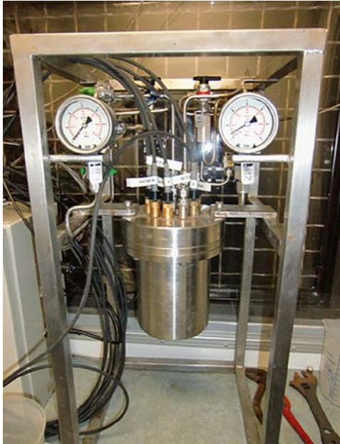
Figur B3-17. SKB:s portabla mätinstrument för underjordsmätning av Eh, pH och grundvattentemperatur. Alla vattenslangar är av PEEK-kvalitet.
