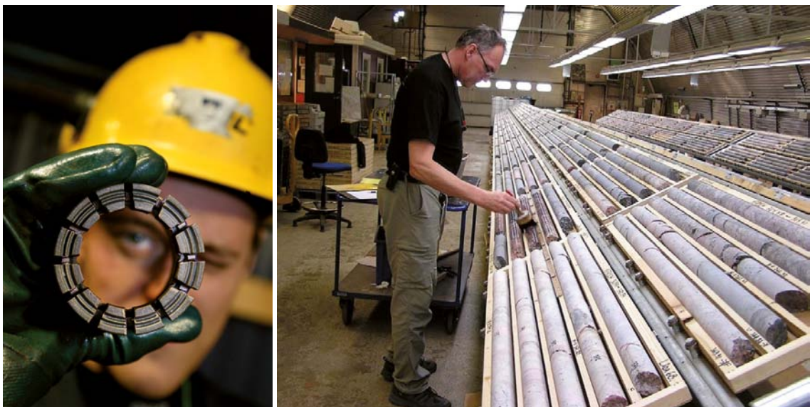
Figur B3-2. Till vänster kärnborrkrona. Till höger kartering av borrhärlor från ett helt kärnborrhål upplagda på karteringsbord.
