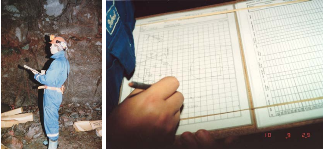
Figur B3-19. Konventionell geologisk tunnelkartering i Äspölaboratoriet. Vid geologisk kartering i slutförvaret kommer papper och penna att ersättas av karteringsdator.
