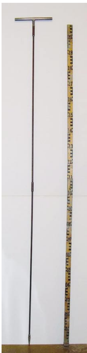
Figur 3-1. Sonderingsutrustningen som användes vid de stratigrafiska undersökningarna. Sonden trycks ned i underlaget och jordarten tolkas utifrån motståndet och friktionen.
