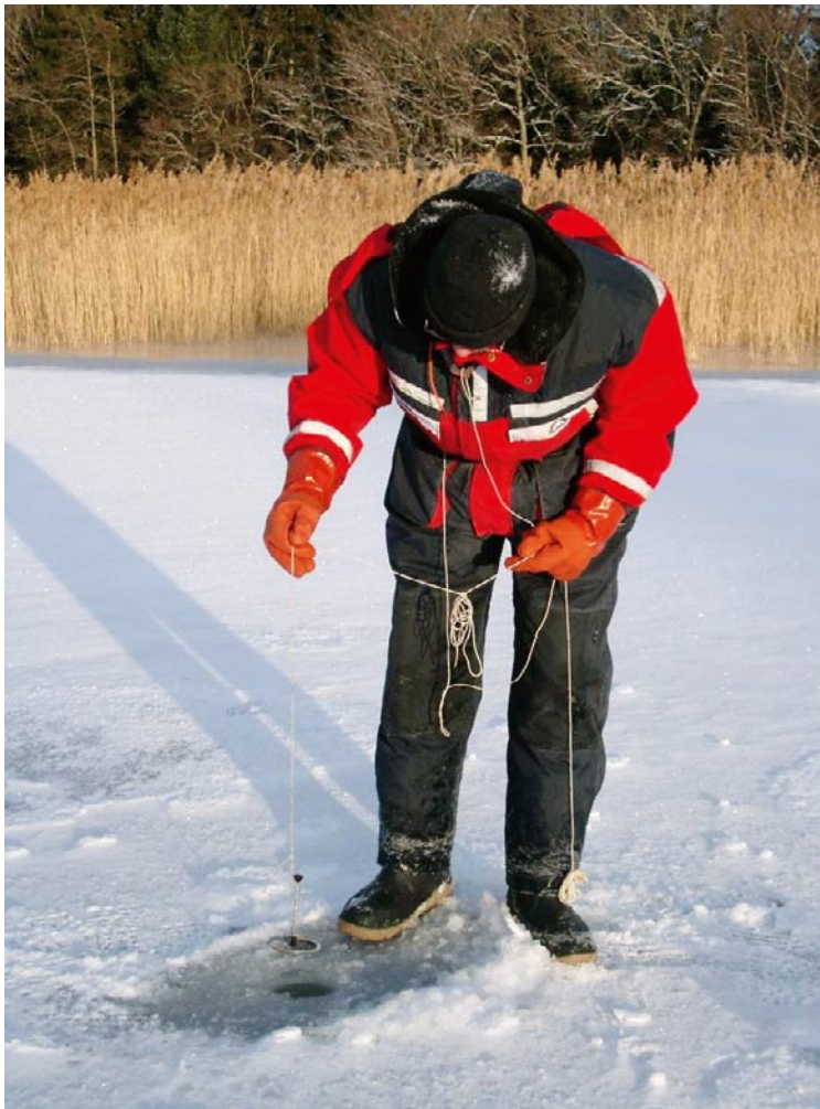
Figur 3-3. Vattendjupet uppmättes med detta enkla lod som sänktes ned till botten och djupet mättes med måttband.
