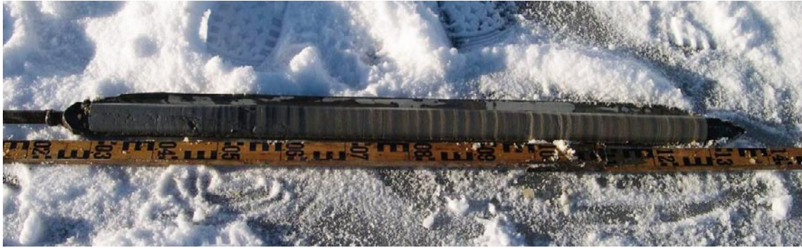
Figur 3-2. Ryssborr användes för provtagning och jordarten karakteriserades vid okulär besiktning. Denna borrhärna är tagen i en annan undersökning vid SFM000012 och visar 1 meter varvig glaciärra.
