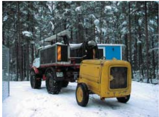
Figur 6. Reflektionsseismik. a) Borrning av laddningshål i jord med tryckluftdriven bormaskin. b) Servicebil för borrning av laddningshålen. Terränglastbilen drar kompressorn. Foto Hans Palm, Uppsala Universitet.
