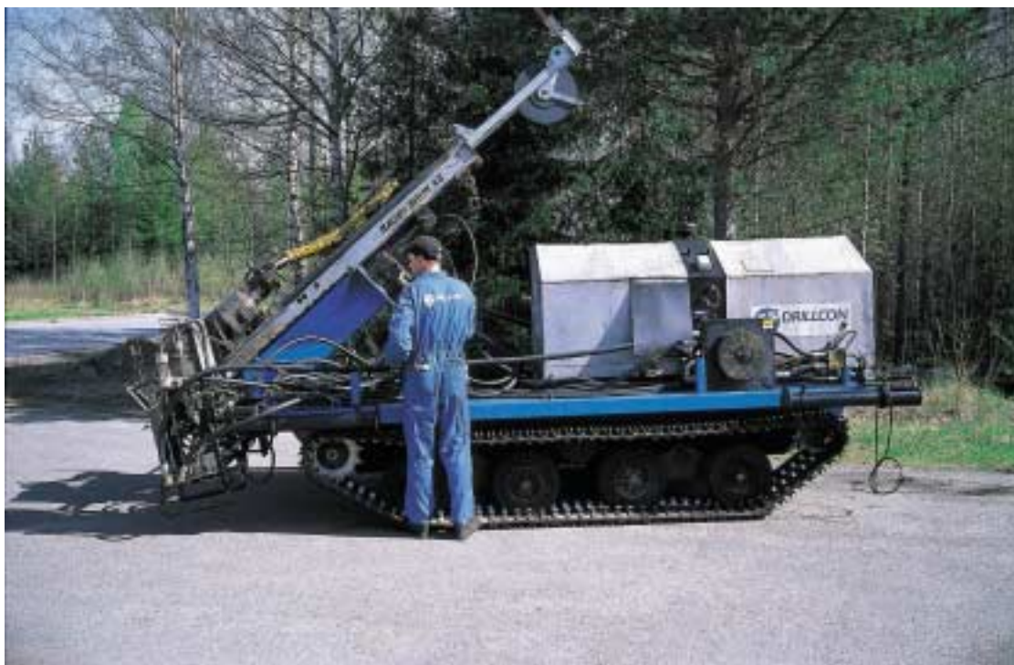
Figur 10. Hammarborrmaskin. Foto G Nilsson.
