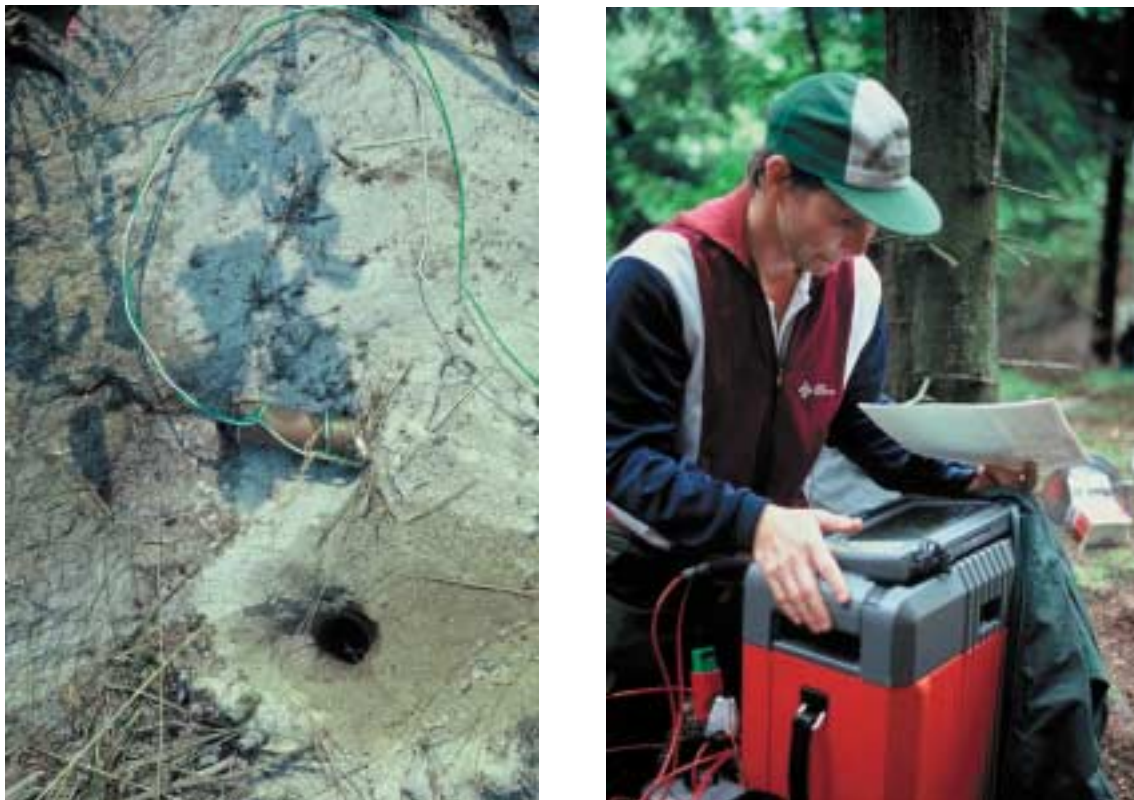
Figur 5. Seismik. a) Borrhål för seismiksprängning i håll. Sprängämnet (del av en Dynamexpatron) ligger apterat, färdigt för placering i borr hålet. b) Seismograf med operatör. Foto Carl-Axel Triumf.
