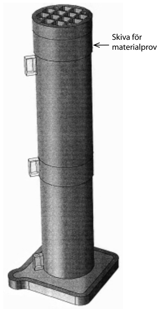
Figur 2-6. Vidgjutna provkroppar nära insatsens botten, mitt och topp. Insatsens extra längd tillåter även att en skiva med höjden 200 mm kan kapas från toppdelen av insatsen.
