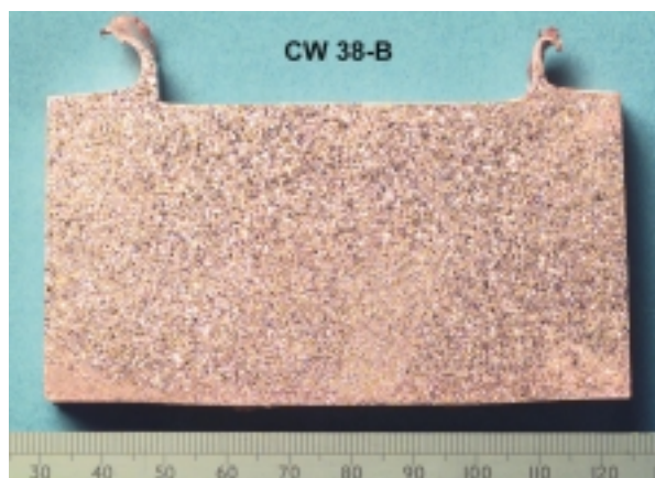
Figur 6-12. Snitt genom svets CW 38.
