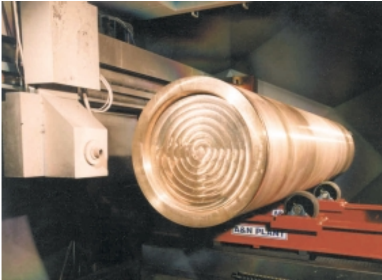
Figur 3-9. Elektronstrålesvetsning av botten på ett kopparrör.
