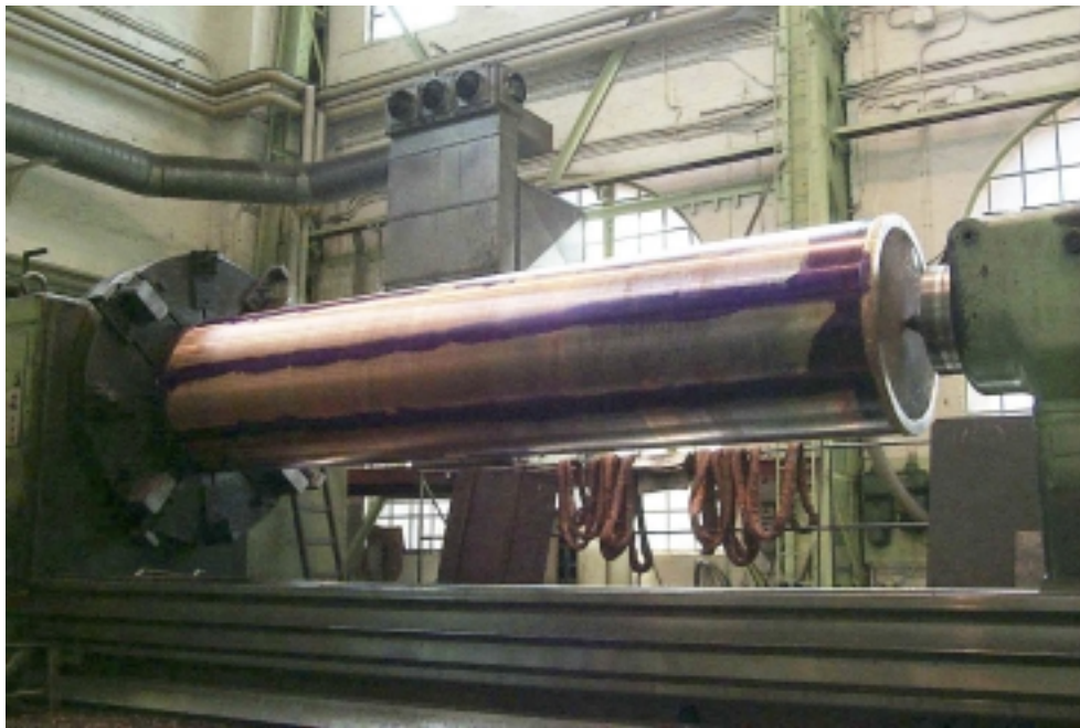
Figur 3-12. Svarvning av rör T 22 efter botten svetsning.
