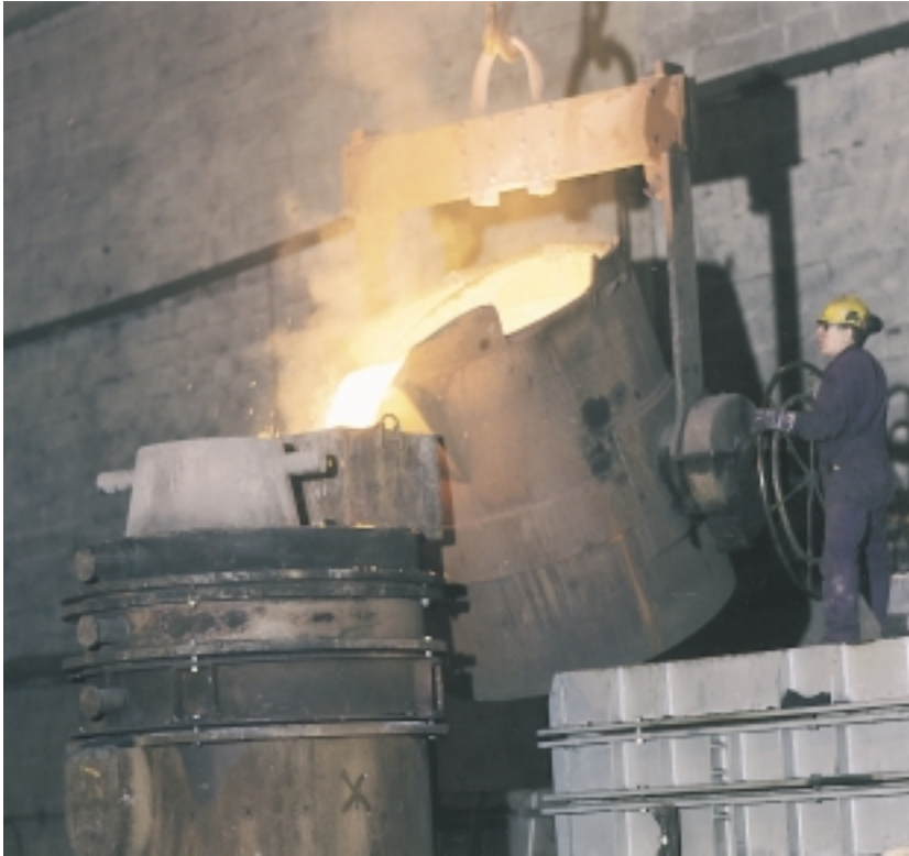
Figur 3-16. Gjutning av en insats.
