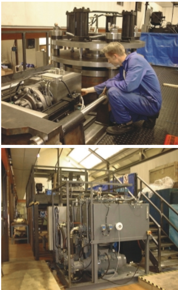
Figur 6-5. Maskin för FSW av lock eller botten på kopparrör.
