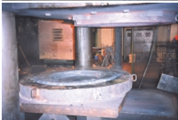
Figur 3-8A–C. Smide av ämnen för lock och bottenar i kopparrör.
