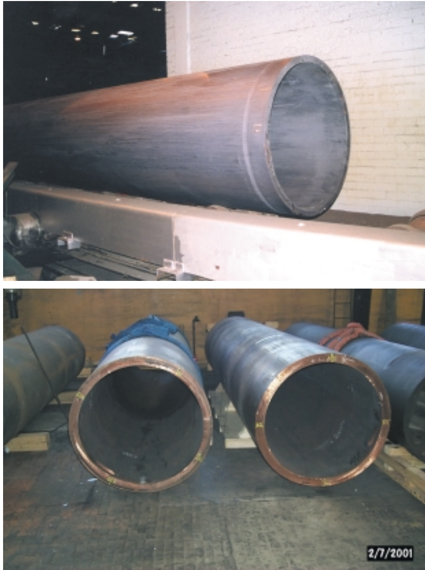
Figur 3-5. Extruderade kopparrör. Överst rör T 22 tillverkat för 30 mm väggjocklek och nederst rör T 28 och T 29 som skall bearbetas till 50 mm väggjocklek.
