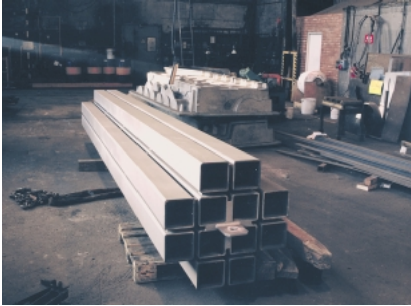
Figur 3-13. Svetsad kassett med 12 kanaler för BWR-element.
