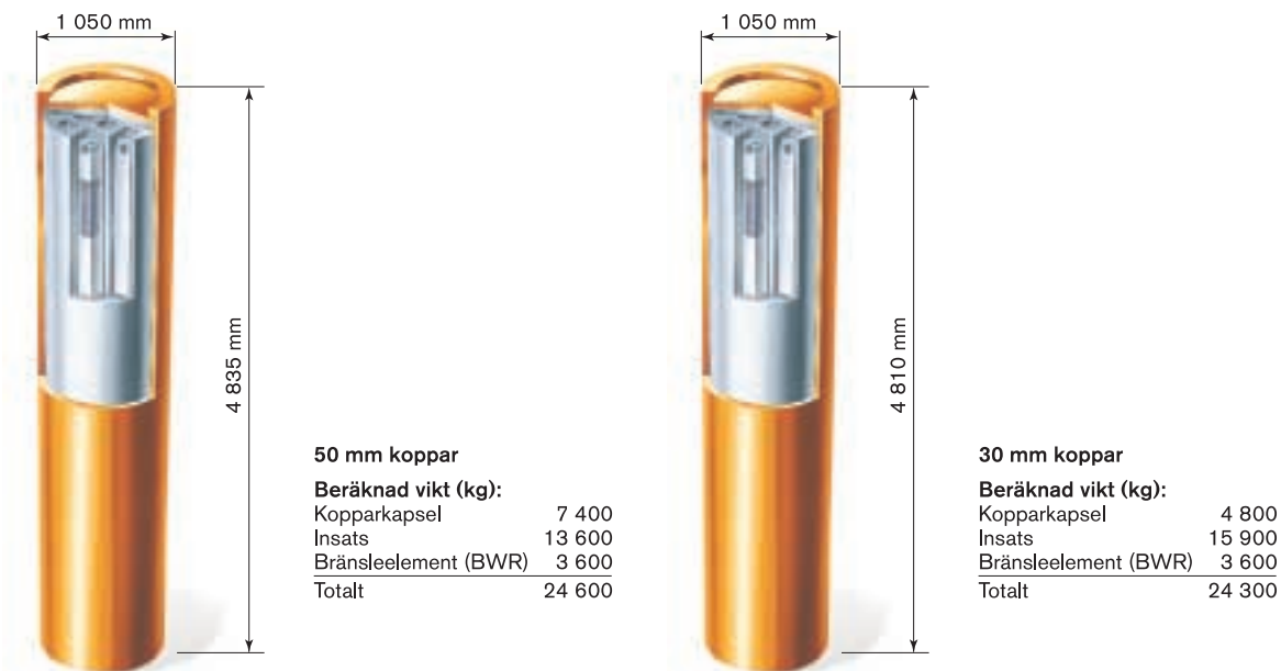
Figur 15-1. Mått och viktangivelser för kapsel med 50 mm och 30 mm vägg tjocklek.
