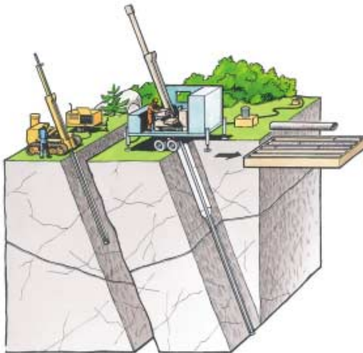
Figur 11-3. Grundare hål hammarborras vanligen (till vänster i figuren), varvid berget krossas till borrkax, medan borrning av djupa borrhål görs med diamantborrkrona, varvid borrkärna tas upp för geologisk kartering. Figuren illustrerar diamantborrning enligt teleskopborrningsvarianten (se avsnittet om kärnborrning).
