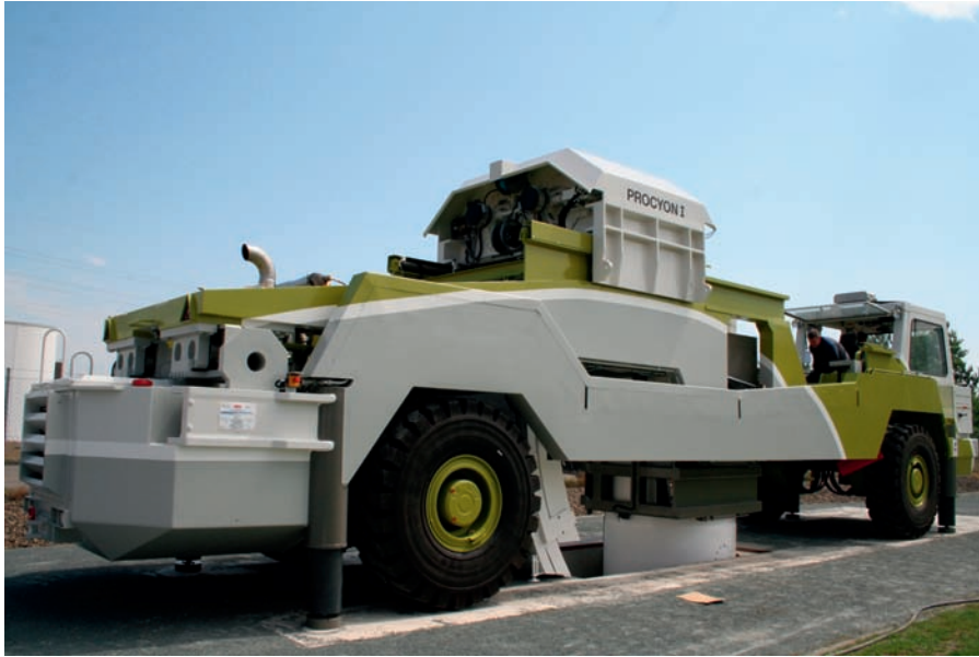
Figur 2-5. Nyutvecklad deponeringsmaskin för hantering av kapslar i slutförvaret.
