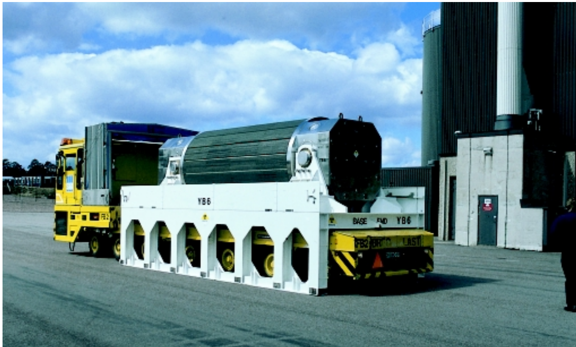
Figur 6-3. Terminalfordon med transportbehållare för använt kärnbränsle.
