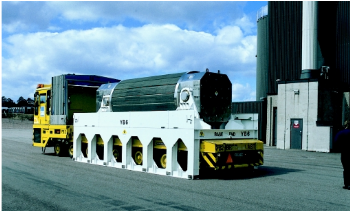
Figur 6-3. Terminalfordon med transportbehållare för använt kärnbränsle.
