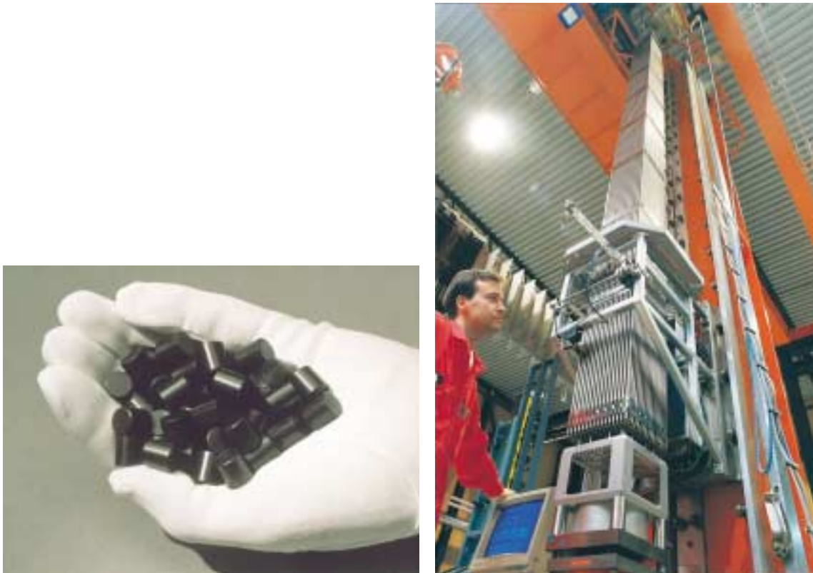
Figur 2-1. Till vänster: Kärnbränslekulsar av urandioxid. Bränslekulsarna placeras i rör av zirkaloy, bränslestavar. Till höger: Ett bränsleelement för en kokvattenreaktor (BWR).
